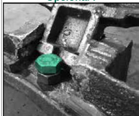
Sistema de tornillo vertical
