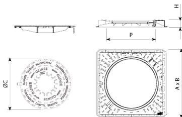
Hexa está diseñada para soportar un tráfico medio. Perfecta para instalar en vías con una IMD de 1.000-20.000, especialmente calzadas de carreteras (incluyendo calles peatonales), arcenes estabilizados y zonas de aparcamiento para todo tipo de vehículos.
