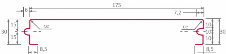
DETALLE DEL PERFIL I DIMENSIONES
